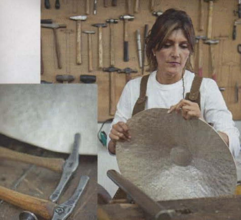
Alexandra, después de experimentar con varias técnicas, elabora muchas de sus obras mediante 'batido', una de las que mayor esfuerzo físico requieren. Consiste en levantar las piezas únicamente con martillo.
